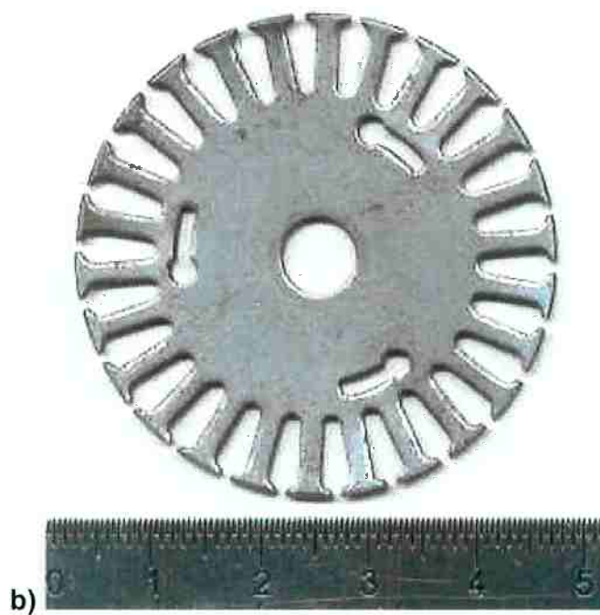
Figura 10: Foto das peças. a) Punção; b) Chapa já cortada.
