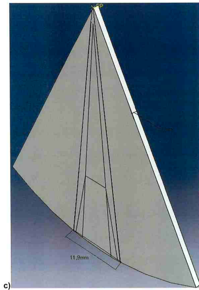
Figura 8: Peças do modelo e suas respectivas dimensões. a) Punção; b) Matriz; c) Chapa.
